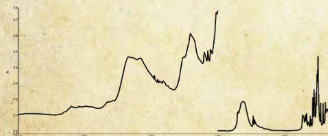
Rysunek 2: Połączone widma glukozy: bliskiej podczerwieni NIR (po lewej, czysty związek) i średniej podczerwieni MIR (po prawej, związek rozcieńczony w pastylce KBr).
